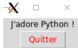
FIGURE 20.3 – Exemple basique de fenêtre Tkinter .
